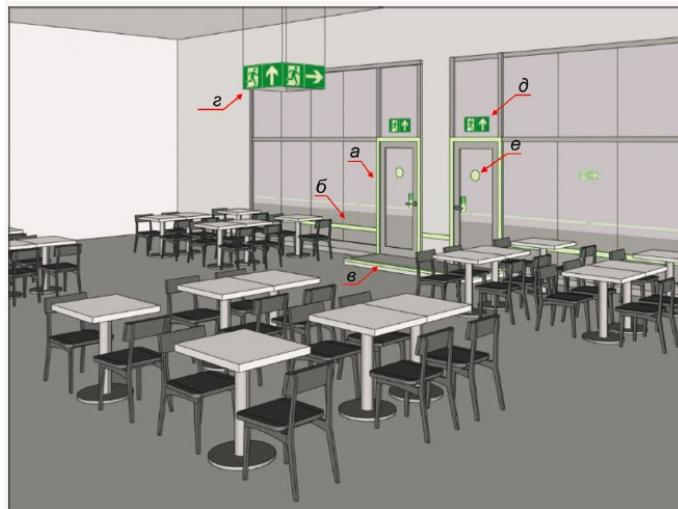
а - обозначение контура и механизма двери; б - обозначение стеклянной перегородки фотолюминесцентной полосой шириной не менее 50 мм; в - обозначение препятствий (ступенек) на полу; г - подвесной указатель направления эвакуации; д - указатель направления эвакуации ("Продолжать движение через эту дверь"), размещенныйный над выходом; е - обозначение стеклянных дверей фотолюминесцентными элементами круглой формы
