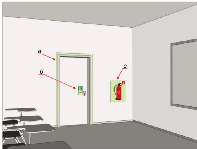
а - обозначение контура двери фотолюминесцентной полосой;
