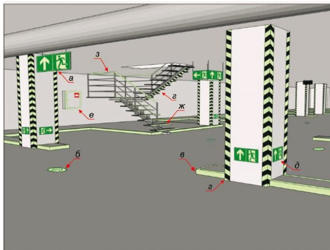
а - подвесной комбинированный указатель направления эвакуации; б - напольный указатель направления эвакуации; в - обозначение препятствий (перепадов пола); г - обозначение опасной зоны или конструкции здания, которая может стать причиной травмы; д - низко расположенный указатель направления эвакуации; е - обозначение места размещения пожарного оборудования; ж - обозначение ступеней и перил лестниц
